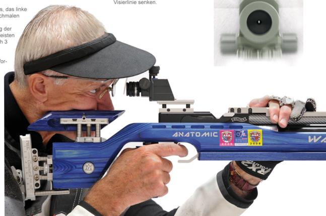
Vor dem Schuss über Diopter und Kornentwurf das Ziel genau anvisieren. Nach dem letzten flachen Ausatmen den Kopf mit einer gefühlvollen Bewegung in die Visierlinie senken.
