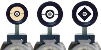
Die richtige Korngröße ist nicht leicht zu finden. Ein zu enger Ring erzeugt ein unruhiges Zielgeschehen und verführt zu überlangem Visieren. Ein zu weiter Ring zeigt die Position nicht genau genug. Experimentiere im Training mit wechselnden Durchmessern, die um 2 Zehntel variieren. Wähle die Größe, die sich leicht auflösen lässt und ein enges Schussbild bringt. Im Wettkampf ein Zehntel aufdrehen, das bringt Ruhe ins Bild.
