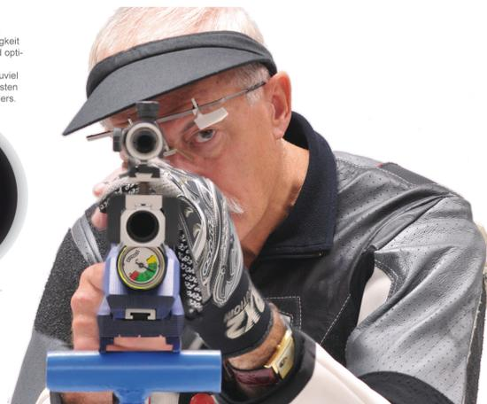
Das Brillen-Glas steht parallel zur Iris, der Abstand zwischen Auge und Iris wird so gewählt, dass der Kornentwurf etwa ein Drittel der Öffnung ausfüllt. Der Kopf ruht mit seinem Eigengewicht auf der Schaftbacke. Höhe und Seite der Backe werden abgestimmt, bis der Blick exakt in die Visierlinie fällt.
